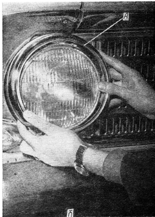
Рис. 67. Снятие декоративного ободка фары: а — вывертывание крепежного винта; б — снятие ободка ( А — декоративный ободок).
